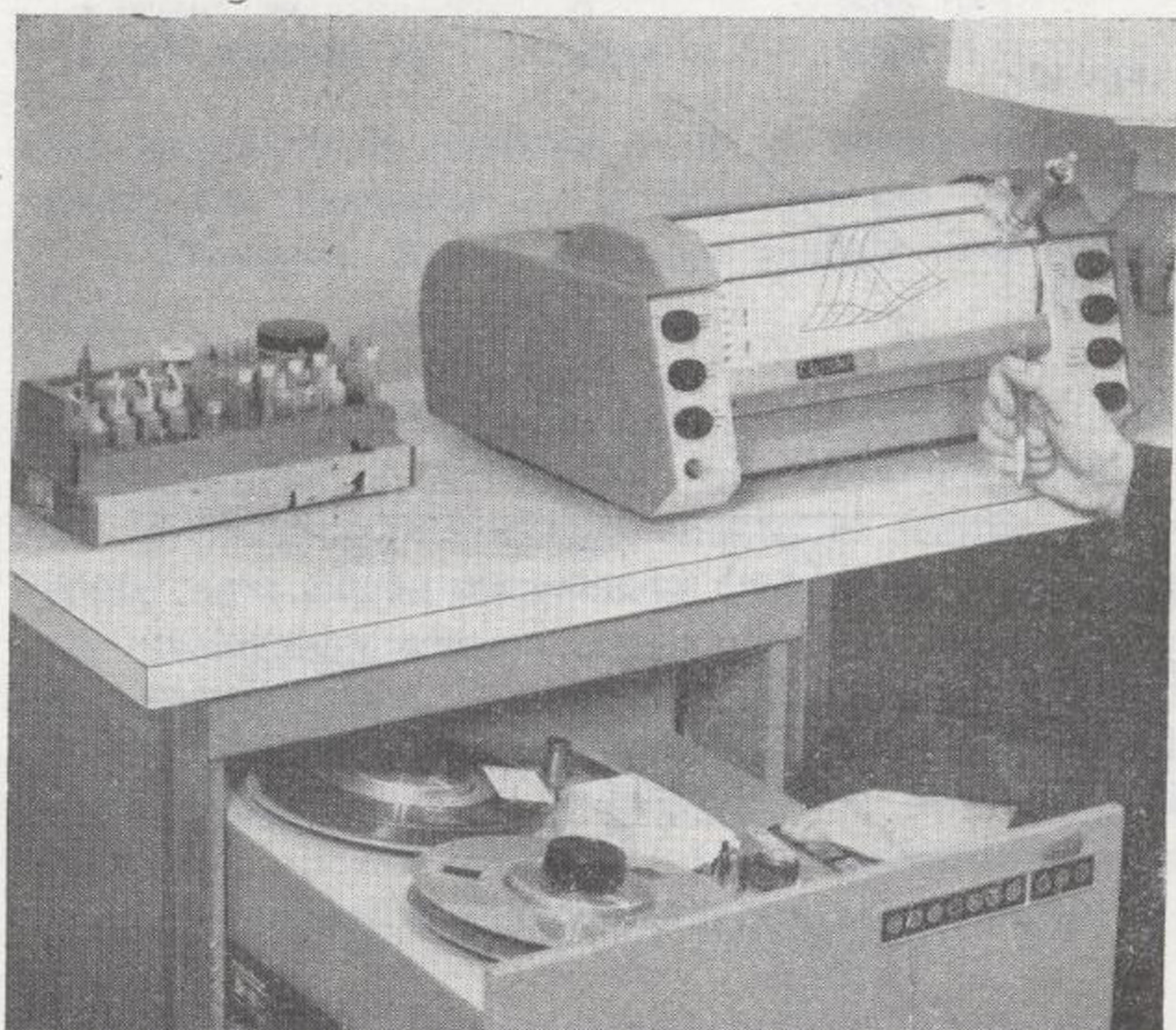
Fig. 15.—Aparato automático para la preparación de gráficas (Cal Comp Digital Plotter, Model 565, off-line via Cal Comp Model 470 tape system). Las gráficas se obtienen por medio del movimiento de la pluma de izquierda a derecha y viceversa, y la rotación del tambor en las dos direcciones.
